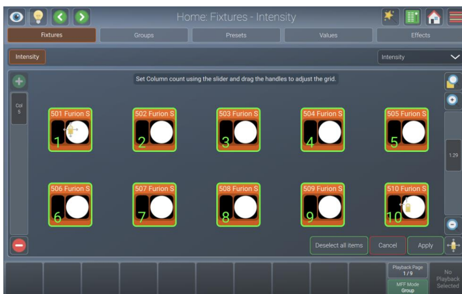
Abb. 96: Fixtures View - Gitter anordnen
