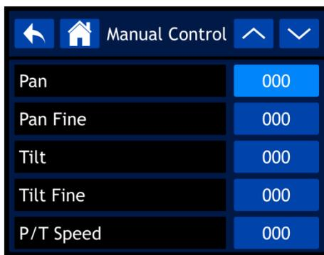
02) Scrollen Sie mit dem Regler oder den Pfeiltasten durch die 23 Funktionen. Diese Funktionen entsprechen den Funktionen der 23 DMX-Kanäle im Betriebsmodus „Advanced“. Siehe **23 Kanäle (Advanced)** auf den Seiten 50-55 für weitere Informationen.
