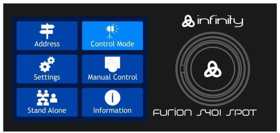
Berühren Sie das Display und drücken und drehen Sie den Regler, um durch das Menü zu navigieren.
